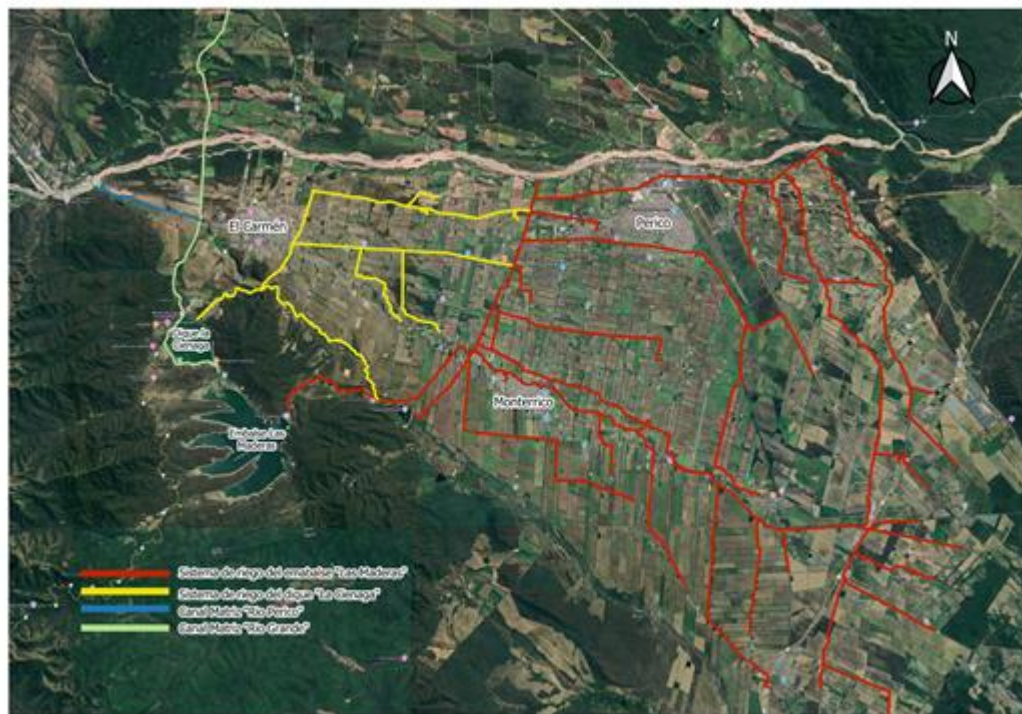
Figura 19:: Distribución de redes de riego en Departamento El Carmén
